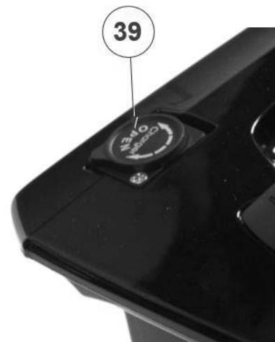
**Abbildung 9** Anschlusspunkt für das Ladegerät
